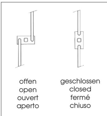
Wassernase des Schlosses im abgesperrten Zustand unten!
