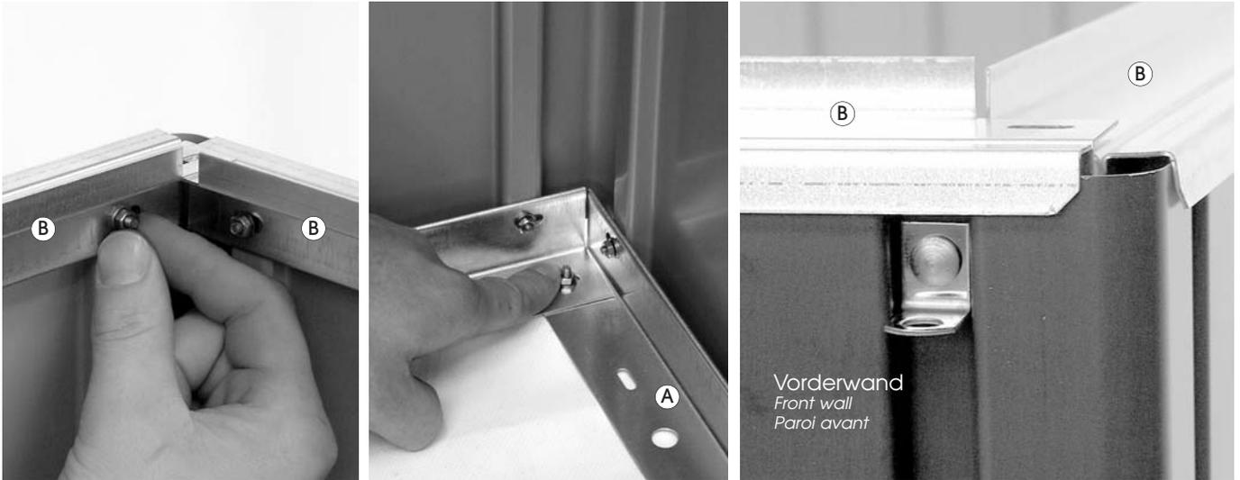
**5.** Befestigen Sie auf dem vorderen und hinteren Kopfprofil **B** die Firststütze **H** jeweils mittig mit einer Schraube. An der Vorderseite über der Türe schieben Sie zwischen Kopfprofil **B** und Firststütze **H** wie abgebildet die Versteifung **F** ein und verbinden sie dieses locker mit dem Kopfprofil (siehe Pfeile). Legen Sie den unteren Firstträger **J3** auf die Firststützen **H** und sichern Sie ihn an jedem Ende mit einer Schraube gegen unbeabsichtigtes Herunterfallen.
