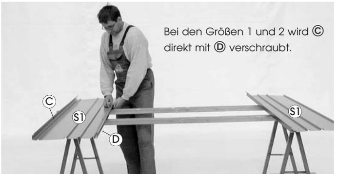
Bei den Größen 1 und 2 wird (C) direkt mit (D) verschraubt.
