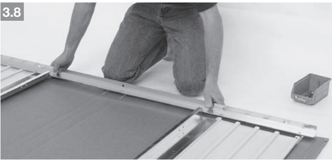
Kopfprofil einschieben & verschrauben | slide & fasten the top frame profile
